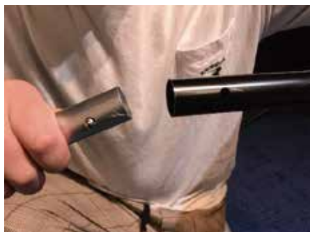
⑤ホリを下げるためのバーを組み立てます。バーにあるボタンを押しながらカチッと音がするまで押し込みます。
