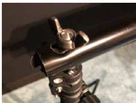
⑧バーをはめ込んだら、蝶ネジを上から締め付けます。
