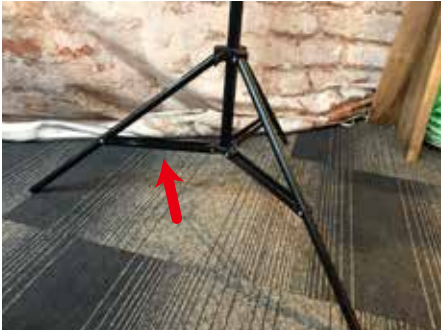
①ネジを緩め、矢印部分が地面と平行になるまで脚を広げ、ネジを締めます。
