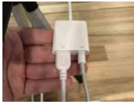
⑤iPhone変換アダプターにiPhone充電ケーブルとミキサーUSBケーブルを挿す。
