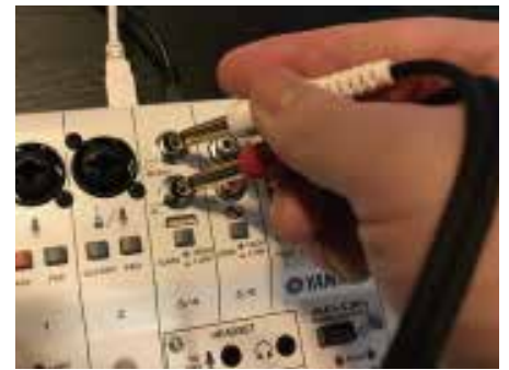
⑥赤白配線(BGM用)を白ミキサーのキーボードマークの端子に挿す。 Lに白、Rに赤
