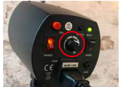
⑥つまみで光の強さを調整します。TESTボタンで明るさのテストができます。
