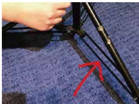
④次に矢印のバーが地面と平行になるまで三脚の足を開き、ネジを締めて足を固定します。
