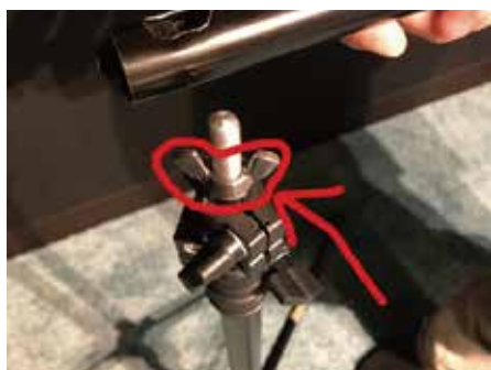
⑦次にバーを三脚に取り付ける前に三脚頭部の矢印の部分の蝶ネジを外します。
