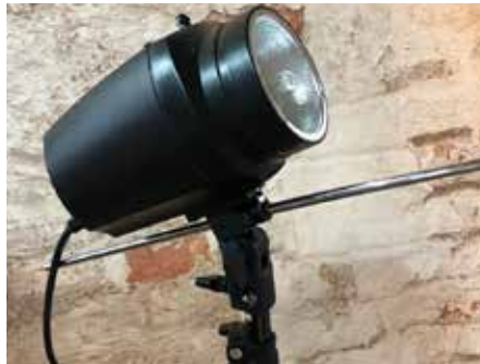
⑤ストロボの首元の傘を挿すネジを緩め、傘を挿しネジを締めます。
