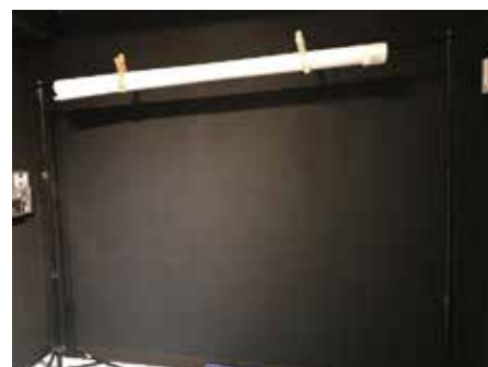
⑨二人で同時に左右の三脚を一つずつネジを緩めながら伸ばして、高さを調節します。
